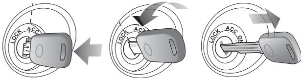
Um den Schlüssel aus dem Zündschloss zu ziehen, drehen Sie ihn gegen den Uhrzeigersinn auf „ACC (UNLOCK) (ZUB ENTRIEGELN)“. Drücken Sie dann den Schlüssel in das Zündschloss und drehen den Schlüssel weiter gegen den Uhrzeigersinn auf „LOCK“ (VERR). Jetzt lässt sich der Schlüssel abziehen.
